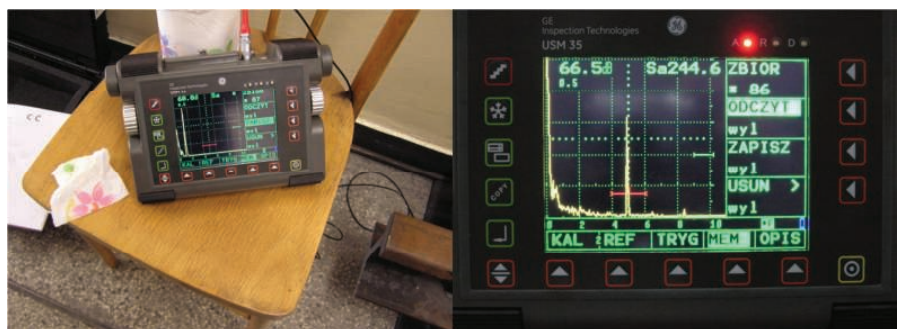
5. Przykład wykorzystania ultradźwiękowej techniki echa [10]
