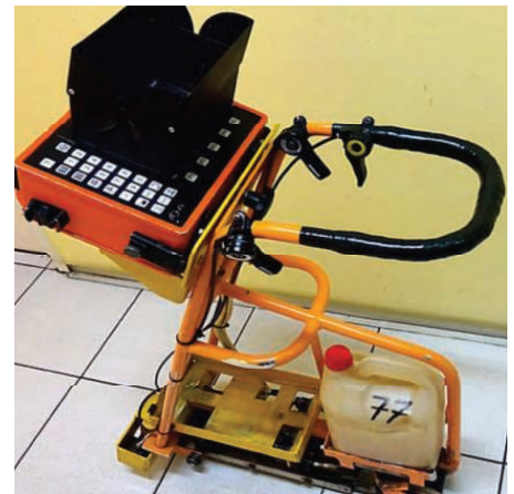
9. Wózek RDM-12 do badania szyn kolejowych [8]
