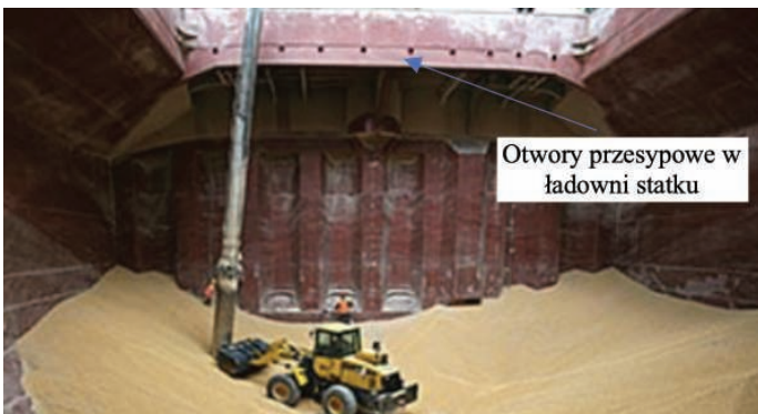
3. Otwory przesypowe w zrębncy luku ładowni statku [7]
