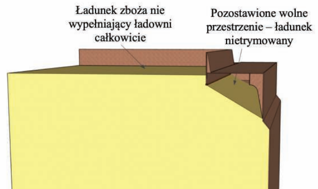
4. Wariant rozmieszczenia ładunku, częściowo wypełniona ładownia w obrębie zrębncy otworu lukowego [6]
