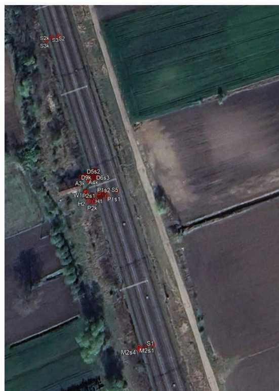
6. Rozmieszczenie elementów sieci sensorowej w pomiarach połowych na linii kolejowej; punkty oznaczają umiejscowienie elementów sieci sensorowej (kontrolery i sensory); w tabeli przedstawiono listę 56 współpracujących elementów (pomiar październik 2025), opracowanie własne z wykorzystaniem narzędzia Google Earth Pro
