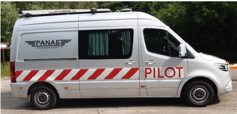
2. Oznakowanie boku pojazdu pilotującego transport ładunków nienormatywnych Źródło: Opracowanie własne
