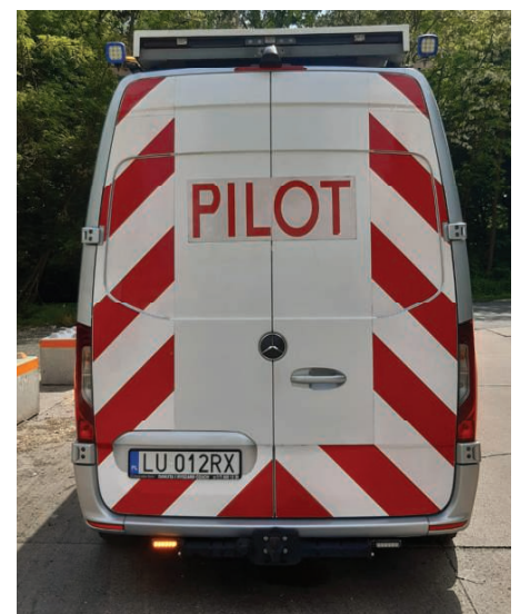
4. Oznakowanie tyłu pojazdu pilotującego transport ładunków nienormatywnych Źródło: opracowanie własne
