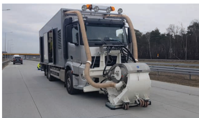
6. Widok maszyny do śrutowania, fot. autorskie
