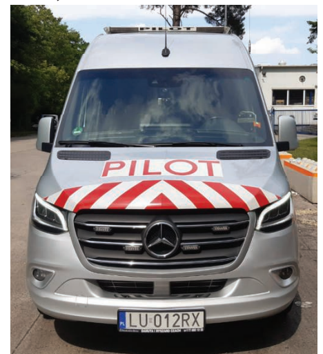
3. Oznakowanie przodu pojazdu pilotującego transport ładunków nienormatywnych Źródło: opracowanie własne
