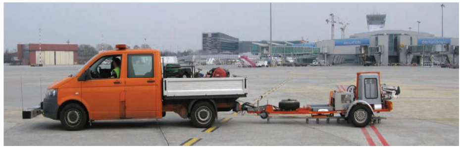
7. Widok ugięciomierza dynamicznego FWD
