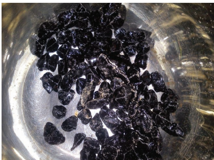
4. Widok kruszywa bazaltowego po badaniu
