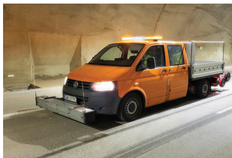
3. Zestaw do pomiarów równości podłużnej (IRI), poprzecznej, makrotekstury oraz współczynnika tarcia w sposób ciągły
