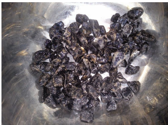
3. Widok kruszywa granodiorytowego po badaniu
