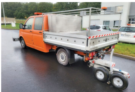
3. Zestaw do pomiarów równości podłużnej (IRI), poprzecznej, makrotekstury oraz współczynnika tarcia w sposób ciągły
