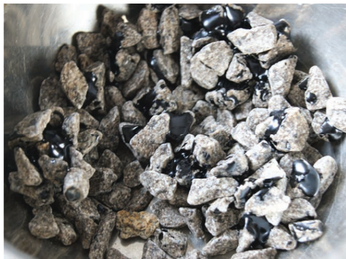
2. Widok kruszywa granitowego po badaniu
