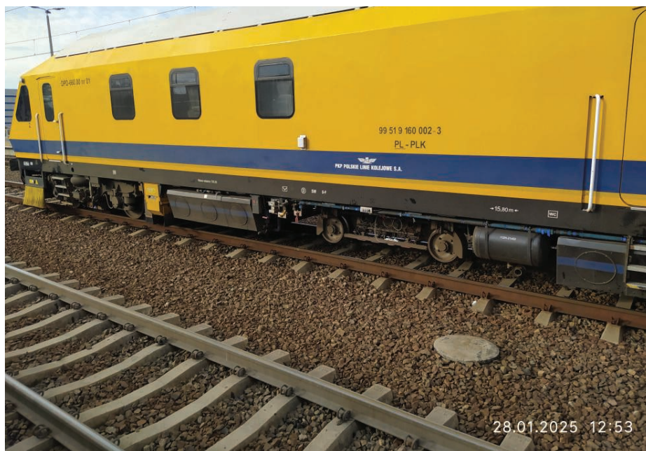
2. Drezyna pomiarowa PLK SA. typ DPD-660 z wózkiem do badań ultradźwiękowych szyn
