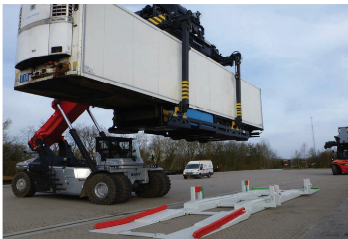
1. Naczepa siodłowa na platformie NiKRASA (Źródło: [2])
