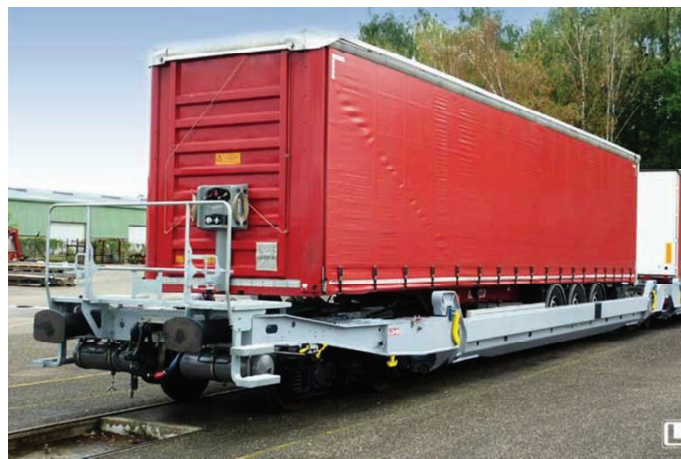
4. Naczepy siodłowe na wagonach podsystemu Modalohr (Źródło:[3])
