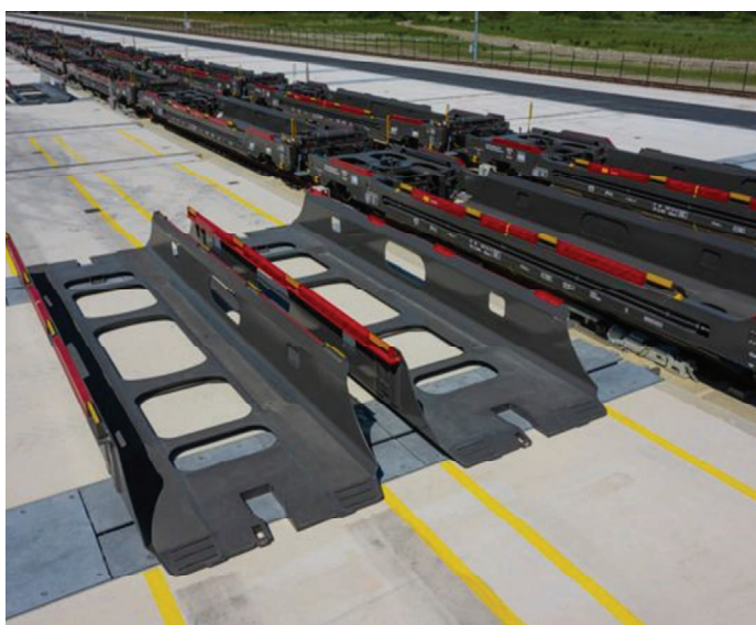
5. Rama przeładunkowa systemu CargoBeamer (Źródło: [4])
