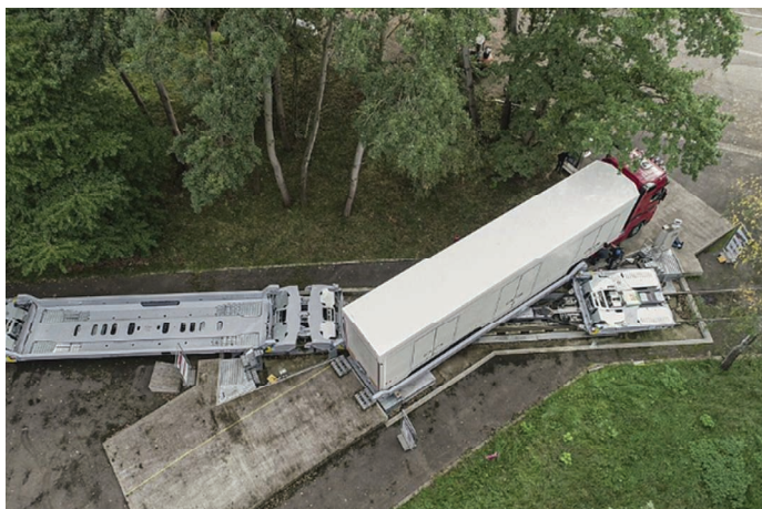
3. Naczepa siodłowa na froncie ładunkowym podsystemu Modalohr (Źródło:[3])
