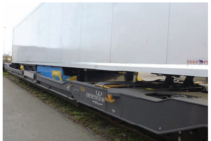
2. Naczepa siodłowa z platformą NiKRASA na wagonie kieszeniowym (Źródło: [2])
