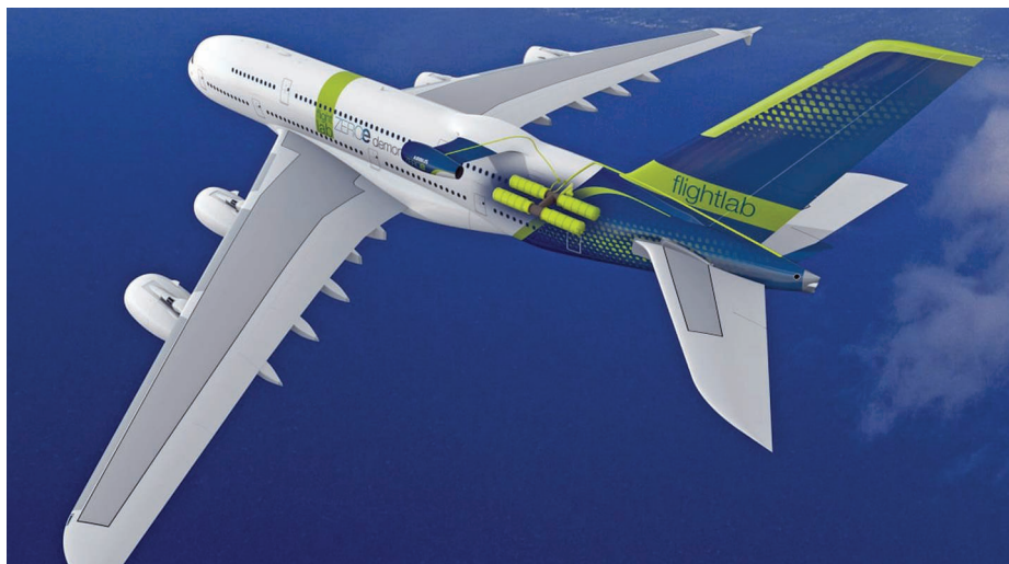
3. Samolot-laboratorium na bazie przebudowanego Airbusa A380 będzie wykorzystywany do testów przyszłościowych wodorowych systemów napędowych dla lotnictwa komunikacyjnego (rys. Airbus)
