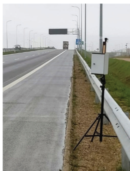
6. Aparatura do pomiaru prędkości pojazdów: a) chwilowej – Sierzega SR4, b) odcinkowej – kamera ANPR (jedna z dwóch na odcinku)
