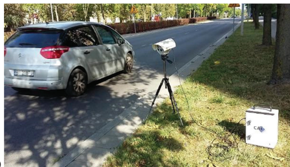
6. Aparatura do pomiaru prędkości pojazdów: a) chwilowej – Sierzega SR4, b) odcinkowej – kamera ANPR (jedna z dwóch na odcinku)
