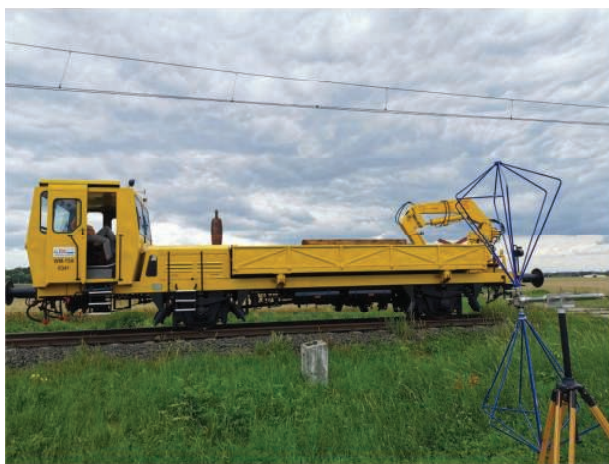
10. Stanowisko do pomiarów emisji zaburzeń promieniowanych w paśmie częstotliwości 30 MHz – 230 MHz
