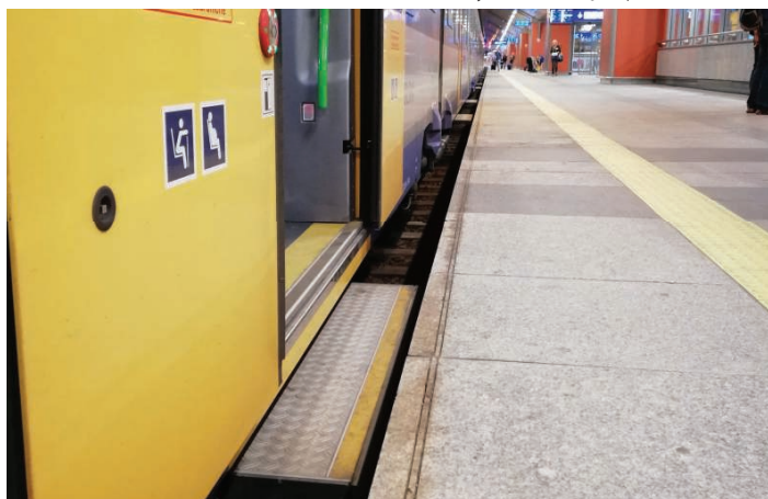
5. Wysuwany stopień przysłaniający lukę (a) oraz rozkładana rampa najazdowa do wagonu (b)
