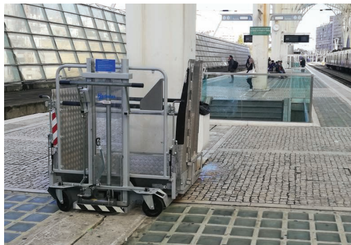
4. Podwyższenie części peronu (a) oraz przenośny podnośnik peronowy (b)
