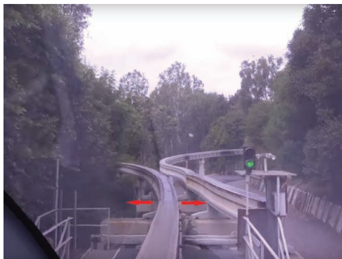
12. Rozjazd wykorzystujący mechanizm przesuwny Źródło: strona internetowa [28]
