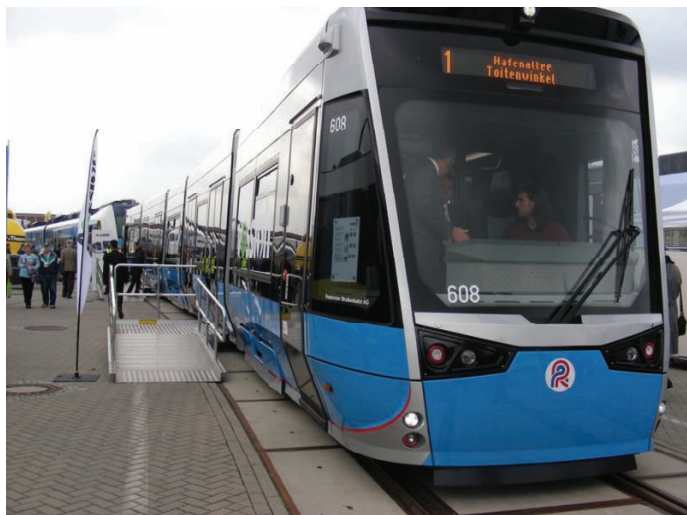
1. Tramwaj Vossloh Tramlink 6N2 dla Rostocku, szerokość całkowita 2,65m, na wysokości peronu – 2,30m, dostosowany do peronów 290mm powyżej pgs
