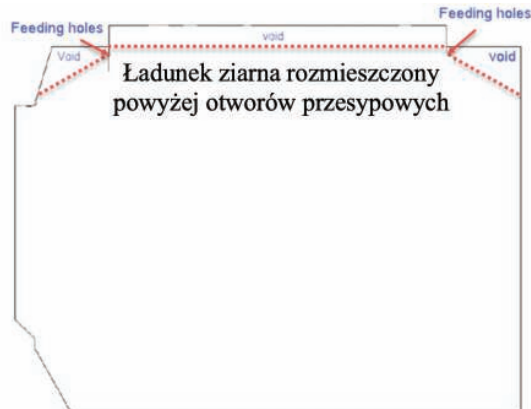
6. Ładunek ziarna powyżej otworów przesypowych – ładunek nietrymowany [7], gdzie void – puste przestrzenie, feeding holes – otwory przesypowe
