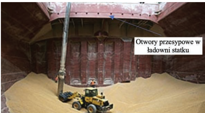
3. Otwory przesypowe w zrębncy luku ładowni statku [7]
