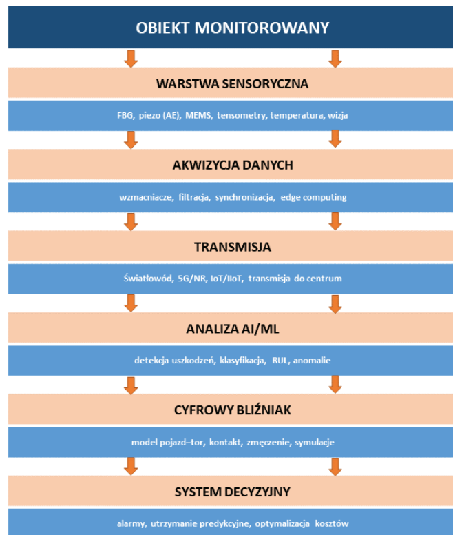
1. Architektura systemu Structural Health Monitoring (SHM) dla infrastruktury i taboru kolei dużych prędkości [źródło: opracowanie własne]
