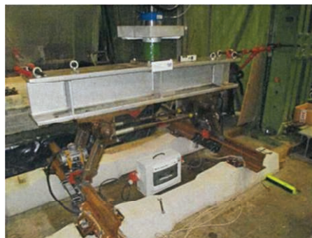
2. Absorber H podczas badań wytrzymałościowych przeprowadzonych zgodnie z normą [12] [opracowanie własne]
