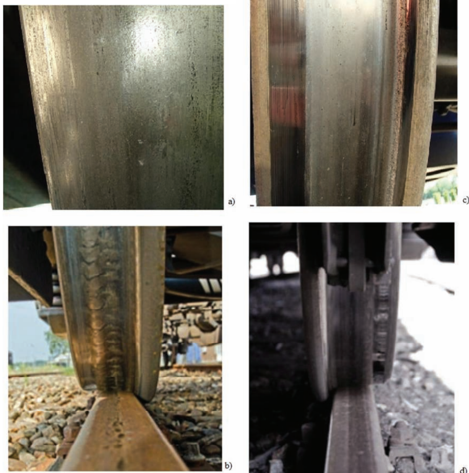
6. Widok na a) i b) koło szorstkie hamowane żeliwnymi wkładkami hamulcowymi, c) i d) koło gładkie hamowane kompozytowymi wkładkami hamulcowymi [17]
