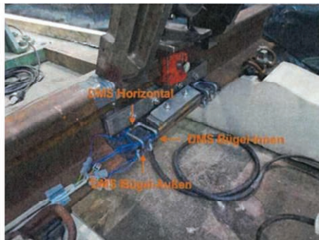
2. Absorber H podczas badań wytrzymałościowych przeprowadzonych zgodnie z normą [12] [opracowanie własne]
