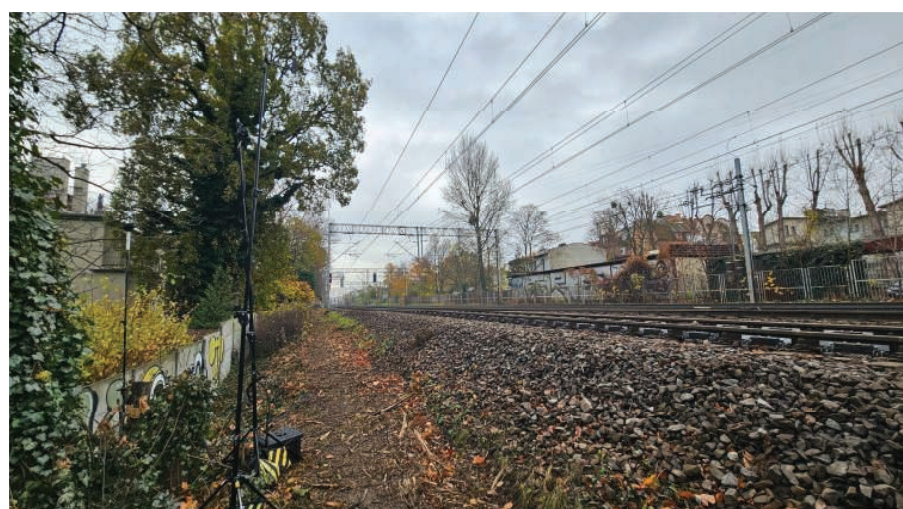
5. Pomiary hałasu zgodnie z [11] na poligonie w Sopocie, tor 501 LK 250 [opracowanie własne]
