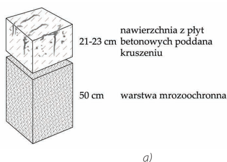
6. Porównanie konstrukcji nawierzchni na DW142: a) stara konstrukcja nawierzchni betonowej; b) nowa konstrukcja nawierzchni (opracowanie autorów na podstawie [8])
