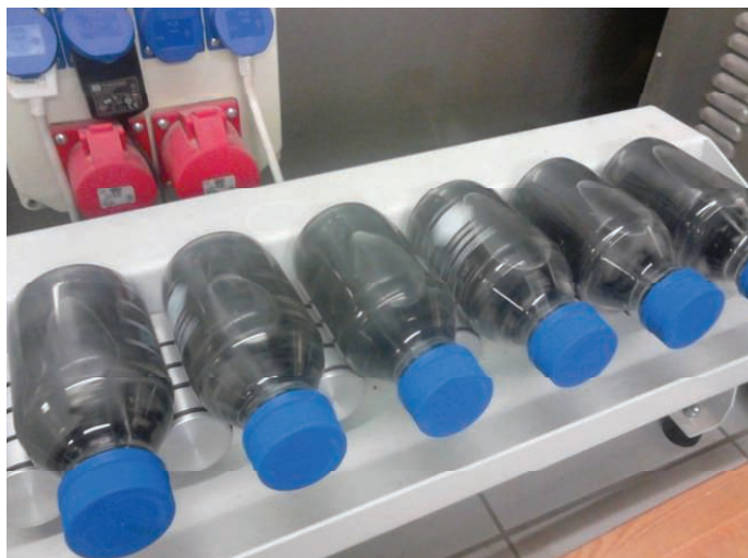
1. Badanie przyczepności asfaltu do kruszywa
