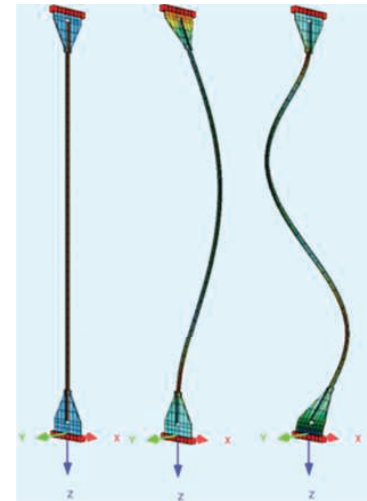
7. Wizualizacja modelu wieżaka w MES oraz podstawowe formy drgań
