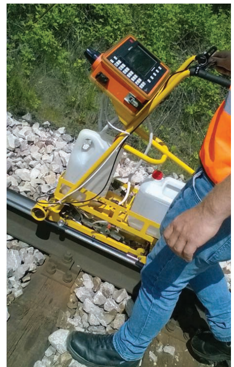
1. Ultradźwiękowe badanie defektoskopowe szyn w torze wózkiem ręcznym jednotokowym
