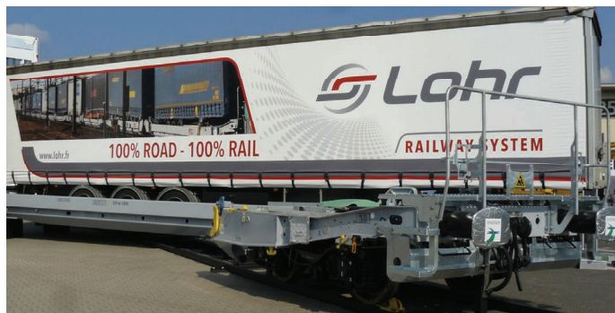
4. Wagon podsystemu przewozu naczep siodłowych „Modalohr” Źródło: ze zbiorów autorów artykułu
