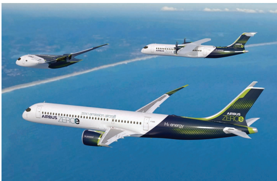
2. Trzy projekty koncepcyjne wodorowych samolotów komunikacyjnych Airbusa opracowane w ramach programu ZEROe, które mogą zostać wprowadzone do eksploatacji do 2035 r.: samolot turbośmigłowy krótkiego zasięgu dla 100 pasażerów, samolot z napędem turbowentylatorowym – średniego zasięgu dla 200 pasażerów i samolot o niekonwencjonalnej – futurystycznej konfiguracji aerodynamicznej bazującej na wykorzystaniu kadłuba nośnego łączącego cechy klasycznego kadłuba, skrzydeł i usterzenia (rys. Airbus)
