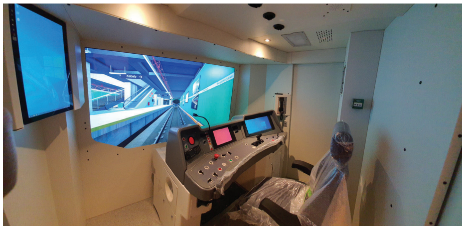
6. Wnętrze kabiny symulatora pojazdu Škoda Varsovia
