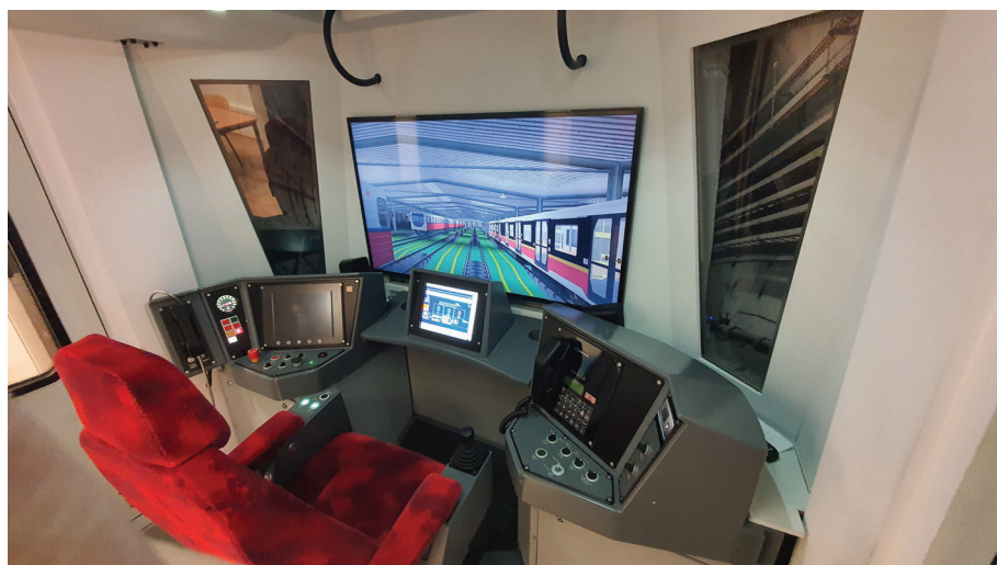
1. Wnętrze kabiny symulatora pojazdu Siemens Inspiro
