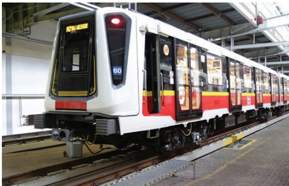
3. Pojazd typu Inspiro. Pojazdy z jednostkami prądu przemiennego (16 x 160 kW). Pudło wagonu jest konstrukcją aluminiową. Masa pojazdu 165 ton.
