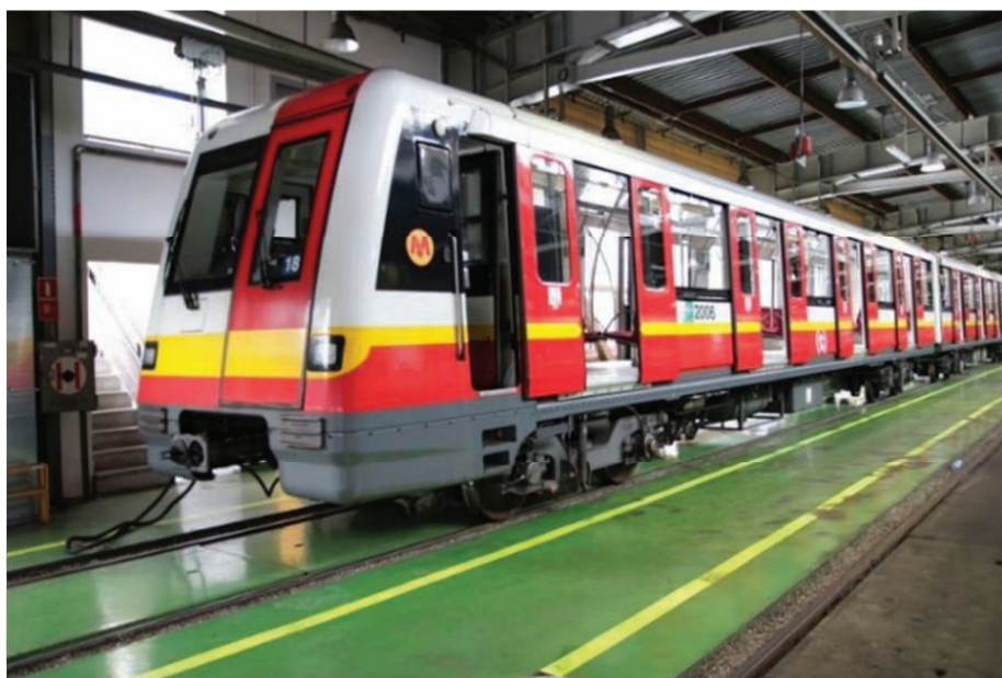
2. Pojazd typu Metropolis. Pojazdy z jednostkami prądu przemiennego (16 x 180 kW). Pudło wagonu jest konstrukcją aluminiową. Masa pojazdu 186 ton.
