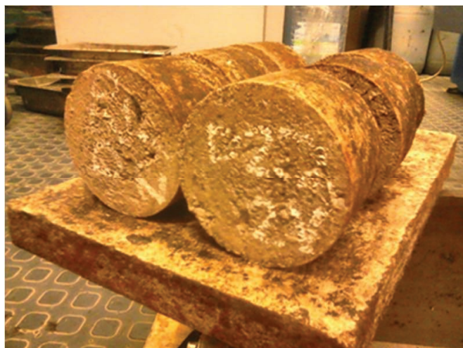
2. Probki do badań wytrzymałości na rozciąganie pośrednie ITS i schemat badania
