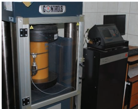
4. Badanie modułu sprężystości próbki materiału do iniekcji geotechnicznej, a) próbka z materiału Cover Geolift 2K przygotowana do badania b) widok próbki z materiału Cover Geopur 2K w maszynie wytrzymałościowej
