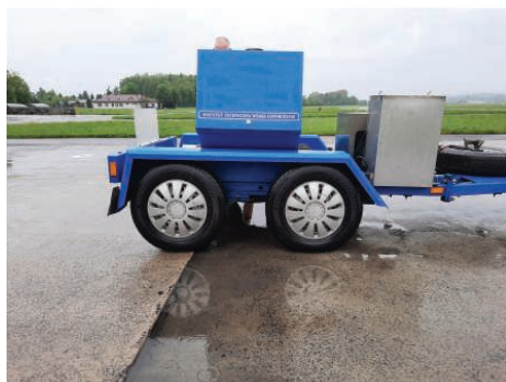
11. Ugięciomierz udarowy typu HWD podczas pomiarów ugięć sprężystych
