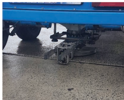
11. Ugięciomierz udarowy typu HWD podczas pomiarów ugięć sprężystych
