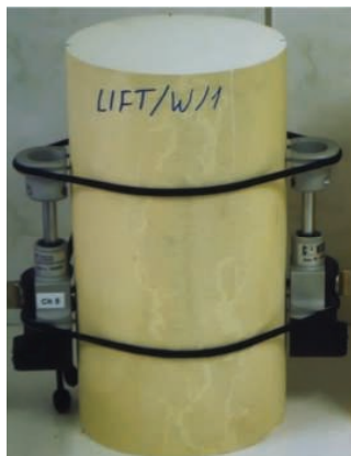
4. Badanie modułu sprężystości próbki materiału do iniekcji geotechnicznej, a) próbka z materiału Cover Geolift 2K przygotowana do badania b) widok próbki z materiału Cover Geopur 2K w maszynie wytrzymałościowej
