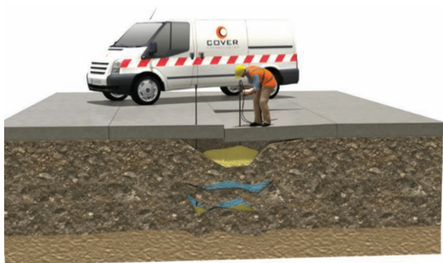
2. Zastosowanie iniekcji geotechnicznej do unoszenia płyty w nawierzchni betonowej
