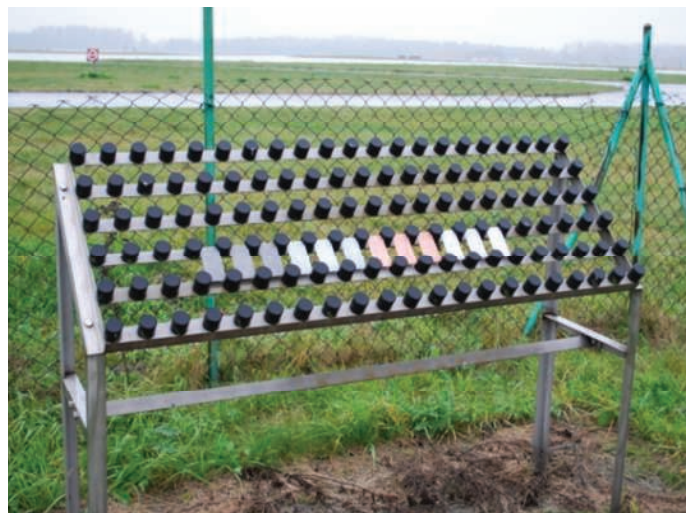
2. Przykładowa stacja korozyjna zlokalizowana na jednym z obiektów lotniskowych
