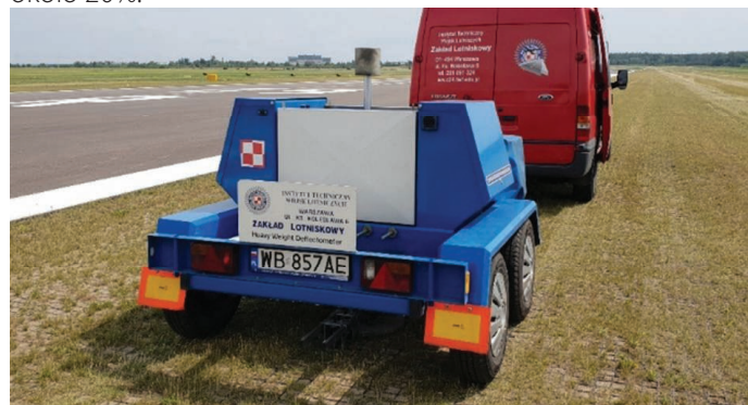
14. Pomiar nośności ugięciomierzem lotniskowym HWD
