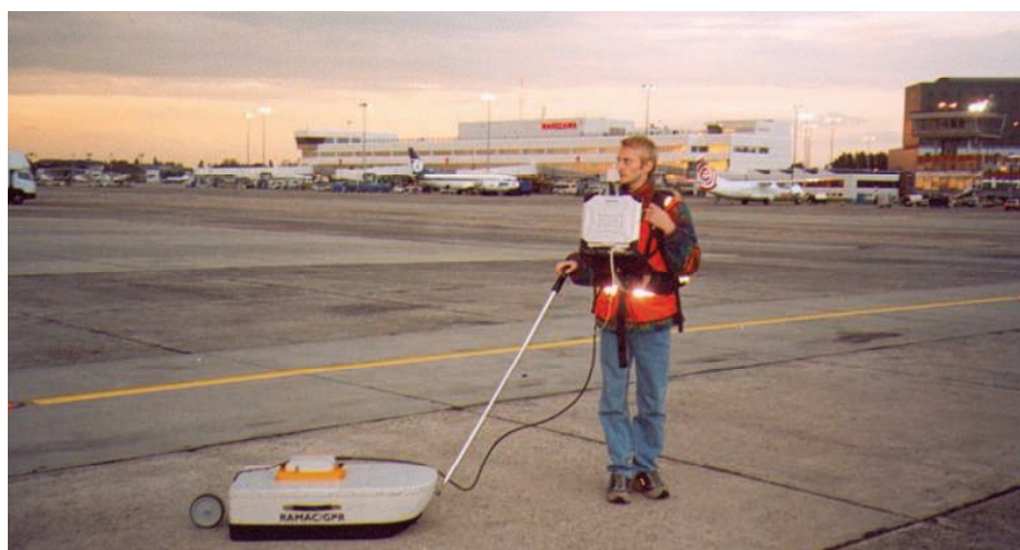
1. Aparatura georadarowa RAMAC/GPR z antenami ekranowanymi 250 MHz
