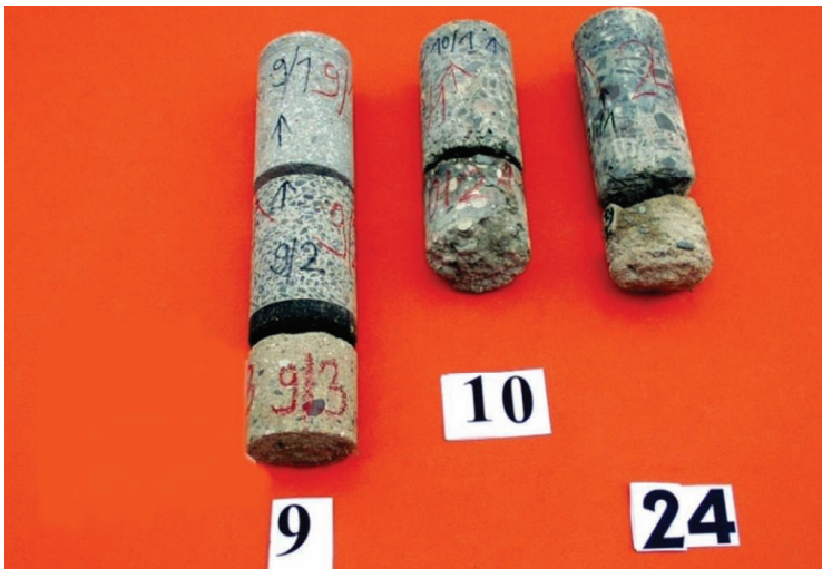
2. Przykłady rdzeni z wierć w nawierzchniach: 9 – rdzeń z nowej nawierzchni, 10, 24 rdzenie ze starej nawierzchni
