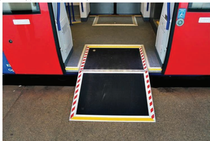
5. Wysuwany stopień przysłaniający lukę (a) oraz rozkładana rampa najazdowa do wagonu (b)
