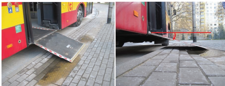
5. Zasięg rampy autobusowej zależy od różnicy poziomów (wysokości) pomiędzy podłogą pojazdu a peronem – im większa różnica wysokości tym większy kąt rozłożonej rampy i większa trudność wjazdu lub wyjazdu wózkami lecz mniejszy „zabór” chodnika
