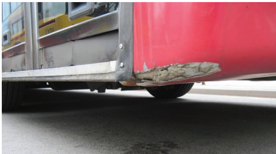
1. Uszkodzona dolna część bryły podwozia autobusu od uderzeń w krawężnie peronów
