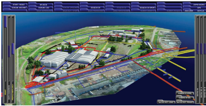
3. Zrzut ekranowy obszaru inwestycyjnego z infrastrukturą szynową, z wizualizacją 3D PROFILI WIRTAULNYCH instalacji podziemnych
