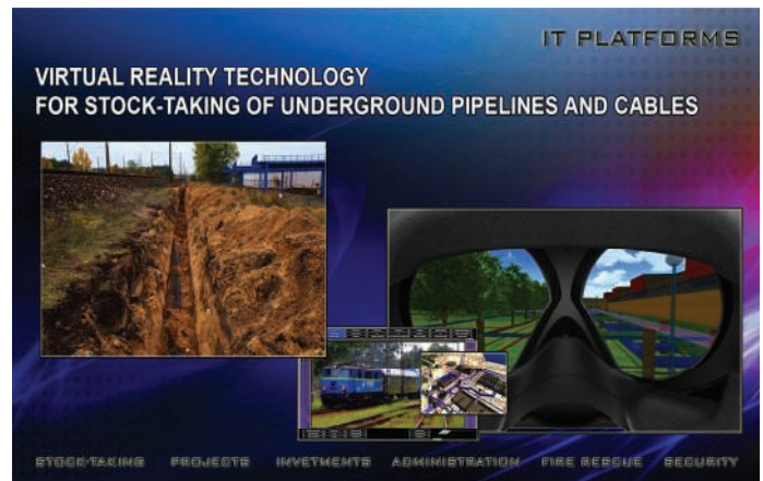
5. Kadry z prezentacji autora artykułu przedstawiający obraz widziany przez gogle wirtualne zinventaryzowanego terenu inwestycyjnego. Przezroczystość gruntu w goglach wirtualnych wynosi w tym przypadku około 90%
