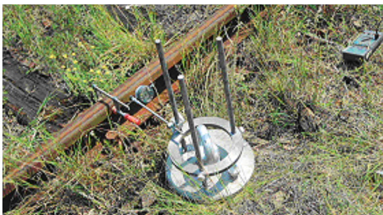
9. Pomiar przemieszczenia podłużnego toru kolejowego w zależności od temperatury (zdjęcie Autora)
