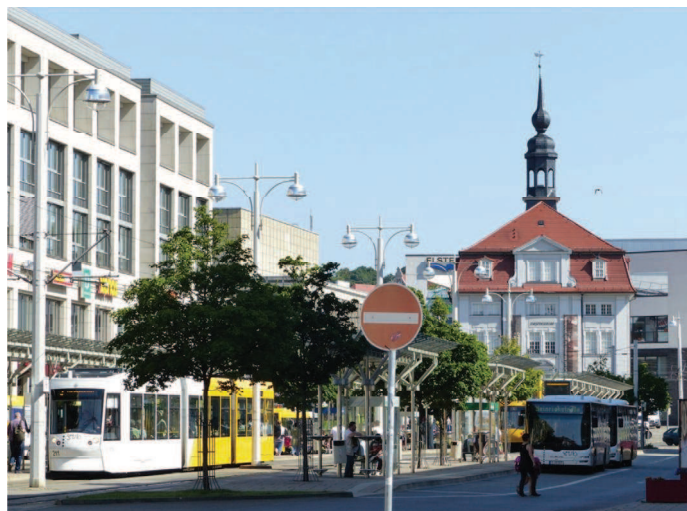
6. Gera, Heinrichstrasse – węzeł przesiadkowy z lewostronnym ruchem autobusów, przez co przesiadki między autobusami i tramwajami odbywają się przez szerokość peronu
