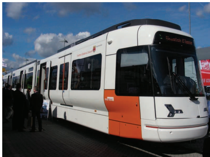
2. Pociąg kolei miejskiej GTZ8-B Vamos dla Bielefeld, szerokość całkowita 2,65m, na wysokości peronu – 2,30m, dostosowany do peronów 920 mm powyżej pgs
