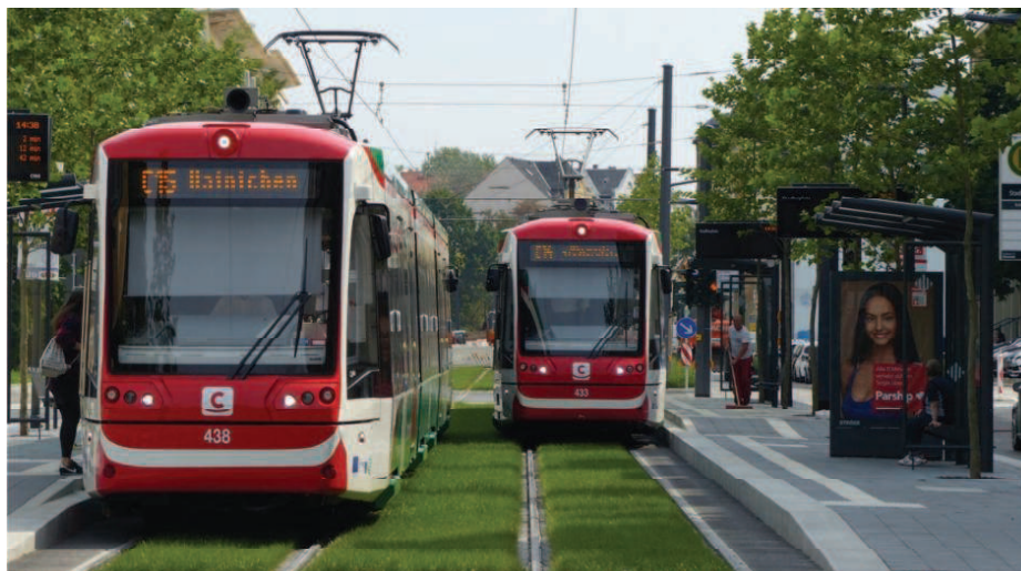
7. Tramwaje Stadler Citylink na przystanku Stadlerplatz w Chemnitz. Widoczne zastosowanie dwóch wysokości elementów Variobord
