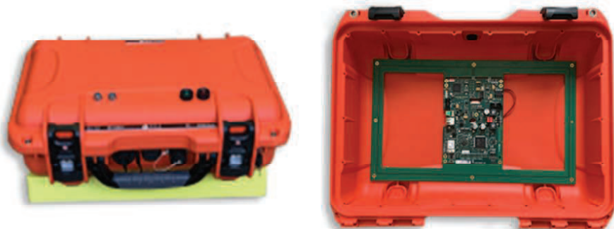
3. Programator Eurobalis typu Q7-UPKE – w wykonaniu standardowym Źródło: materiały wewnętrzne firmy Rail-Mil [4]
