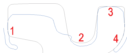
11. Nałożenie przekroju zużytego (kolor niebieski) na nominalny (kolor szary) w oparciu o powierzchnie odniesienia (kolor czerwony)
