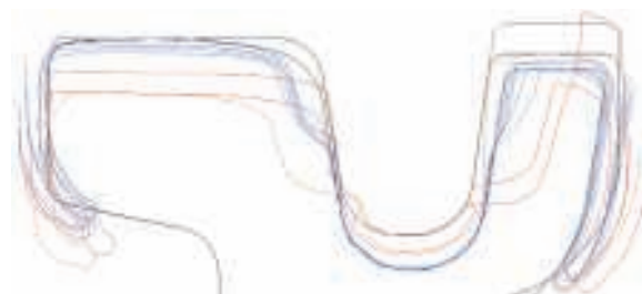
14. Porównanie kształtów zużycia szyn toru o tym samym typie geometrii ale dla różnego ich wieku (opis w tekście)
