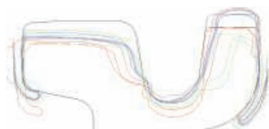
13. Porównanie kształtów zużycia szyn w tym samym wieku ale dla różnych przypadków geometrii toru (opis w tekście)
