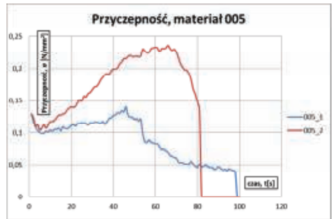
8. Przyczepność przez odrywanie dla próbki materiału nr 005 – wyznaczone na próbce po badaniu odporności na warunki atmosferyczne
