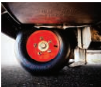
4. Widok od lewej: a) koła pomiarowego z dyszą układu podającego wodę, b) stanowisko do kalibracji statycznej przetworników tensometrycznych zamontowanych w urządzeniu CSR (1- miejsce na oponę koła pomiarowego (stolik przesuwany) 2 i 3 – tensometryczne przetworniki siły do kalibracji odpowiednio siły pionowej i momentu)
