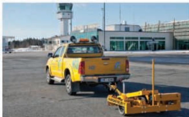
3. Griptester MK2 (po lewej) [12], Skiddometer BV11 (po prawej) [13]
