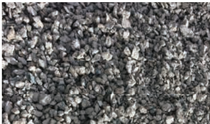
3. Recyklowane kruszywo betonowe uzyskane po przekruszeniu płyt
