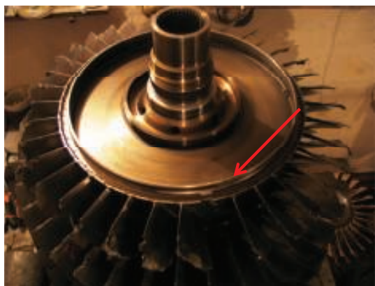
2. Wirnik wentylatora silnika RD-33 z uszkodzoną tarczą IV stopnia oznaczoną jako „1” w stanie dostarczenia do badań, na rysunku zaznaczono widoczne pęknięcia tarczy IV stopnia
