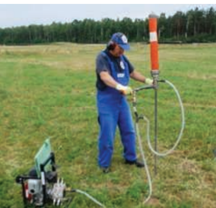
9. Sondowanie sondą DPL
