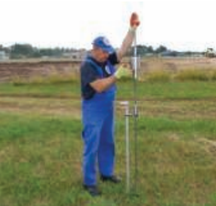
10. Sondowanie sondą DCP
