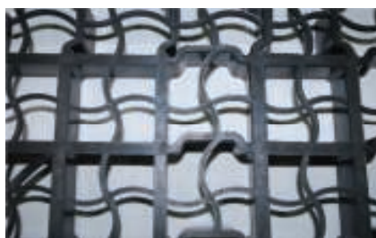
5. Wygląd geokraty użytej do wzmocnienia naturalnych nawierzchni lotniskowych
