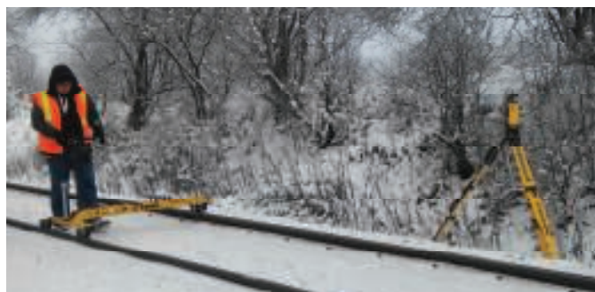
6. Pomiar torów metodą jednowózkową
