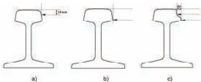
4. Zasada ustalania położenia punktu pomiarowego na główce szyny
