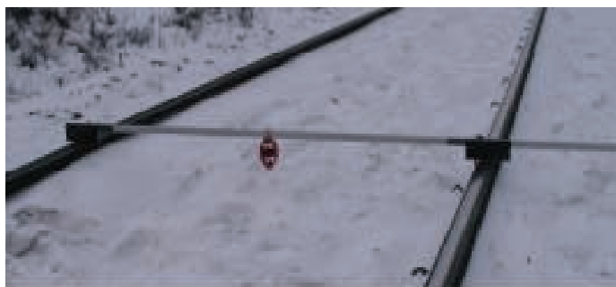
5. Przyrząd do identyfikacji i pomiaru osi toru
