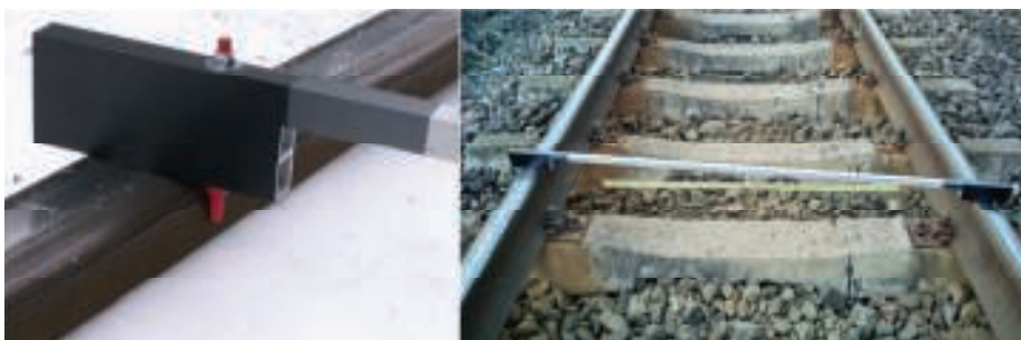
10. Przyrząd pomocniczy do ustalania osi toru
