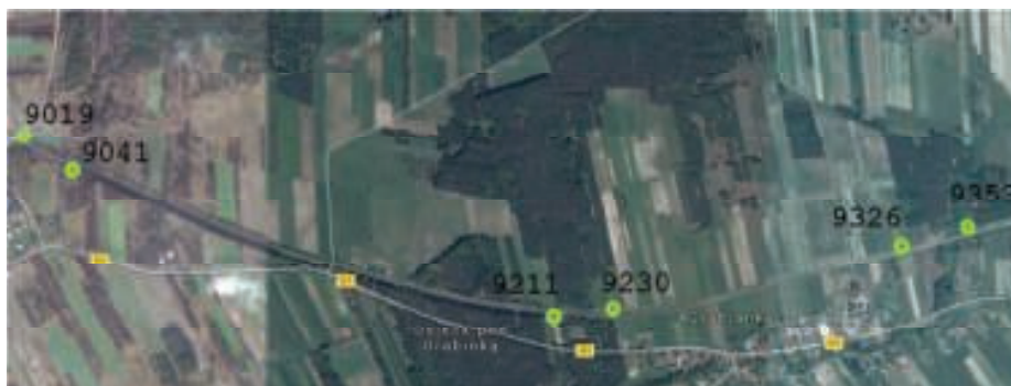
9. Rozmieszczenie punktów osnowy podstawowej
