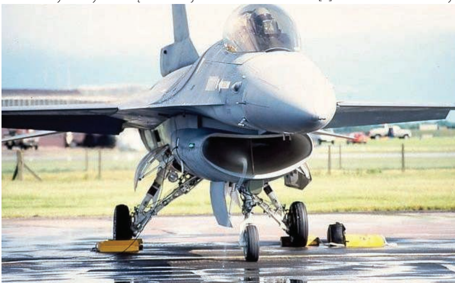
6. Widok wiru przed wlotowego zasysającego z nawierzchni lotniskowej
