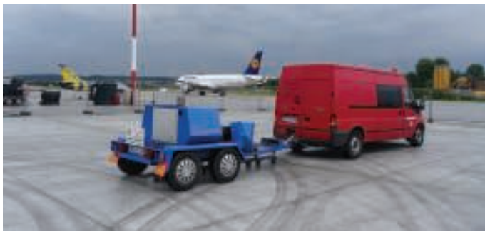
2. Pomiar ugięć sprężystych nawierzchni lotniskowej
