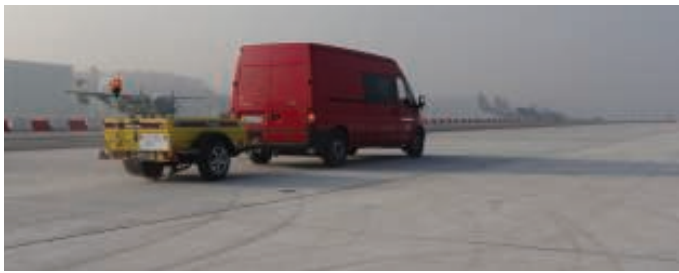
4. Widok pomiarów współczynnika tarcia na betonowej nawierzchni lotniskowej
