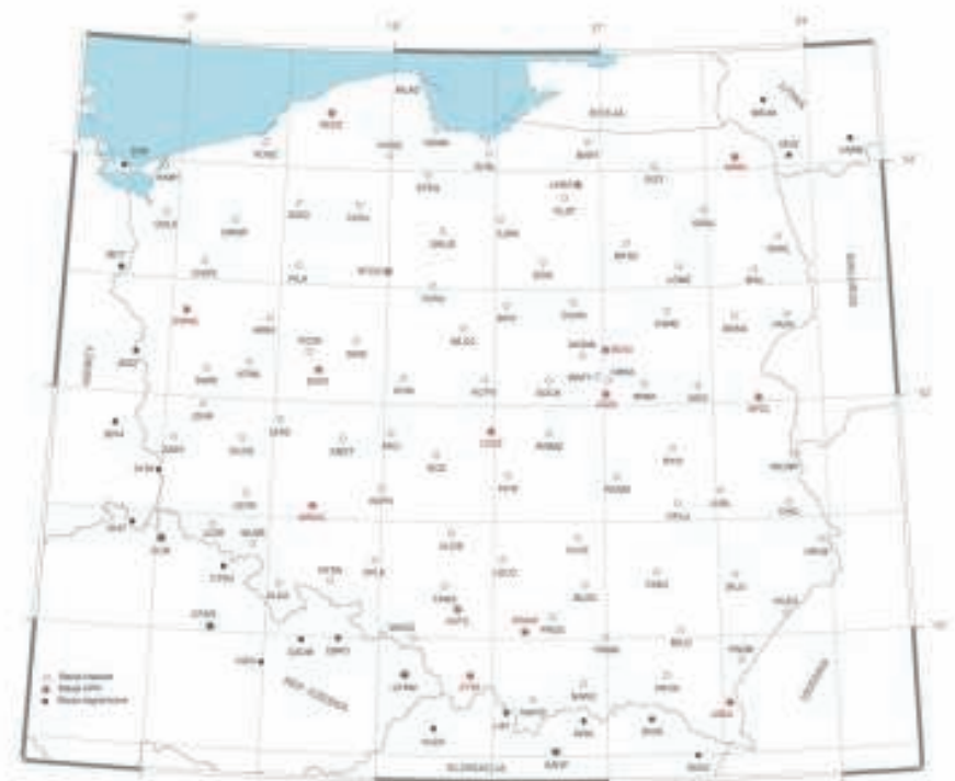
3. Rozmieszczenie stacji systemu ASG EUPOS, gdzie: GLO (GPS/GLONASS), MET (meteorologiczne zestawy pomiarowe), EPN (europejska), IGS (międzynarodowa). Źródło: http://www.asgeupos.pl
