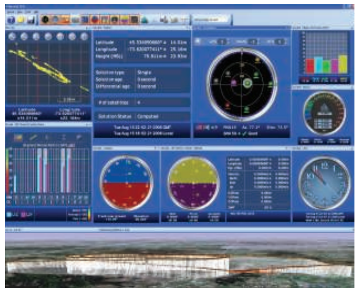
5. Wyniki pierwszych lotniczych testów SPAN (2007, samolot Mewa): panel sterowania systemu, uzyskiwane położenie – przekrój w pionie. Źródło: opracowanie własne
