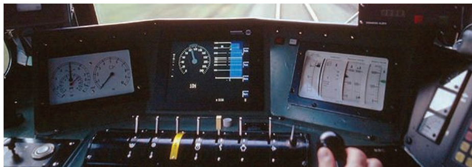
8. Podzespoły sygnalizacji kabinowej w systemie ERTMS/ETCS [15]
