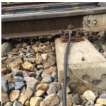
9. Aparatura pomiarowa i lokalizacja czujników pomiarowych w rozjeździe, a- czujniki na szynie i podrozjezdniczy, b- czujnik w podtorzu, c- aparatura pomiarowa, Siedlce sierpień 2016r.
