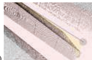
8. Obraz z skanera 3D typu Skorpion, a – iglica, b – krzyżownica
