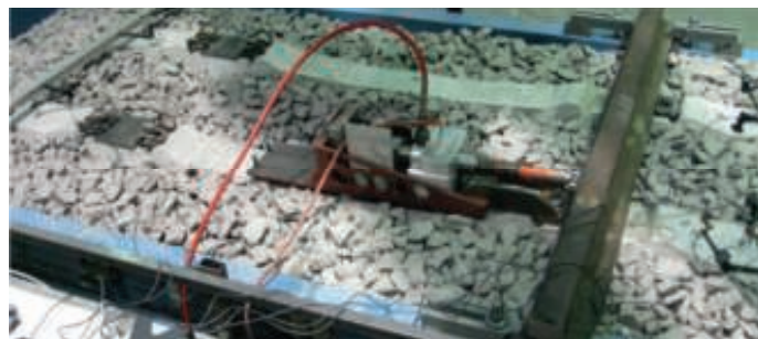
3. Stanowisko badawcze oporu porzecznego w podrozdniczcy z PPP w korycie balastowym
