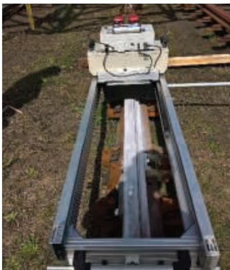
7. Pomiar skanerem Skorpion nowej iglicy w Track Tec Koltram Zawadzkie, kwiecień 2016
