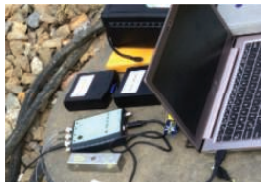
9. Aparatura pomiarowa i lokalizacja czujników pomiarowych w rozjeździe, a- czujniki na szynie i podrozjezdniczy, b- czujnik w podtorzu, c- aparatura pomiarowa, Siedlce sierpień 2016r.
