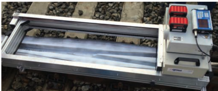
5. Pomiar skanerem 3D Skorpion krzyżownicy w rozjeździe z PPP na stacji Siedlce, luty 2016
