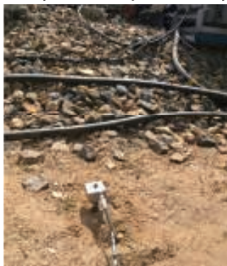
9. Aparatura pomiarowa i lokalizacja czujników pomiarowych w rozjeździe, a- czujniki na szynie i podrozjezdniczy, b- czujnik w podtorzu, c- aparatura pomiarowa, Siedlce sierpień 2016r.
