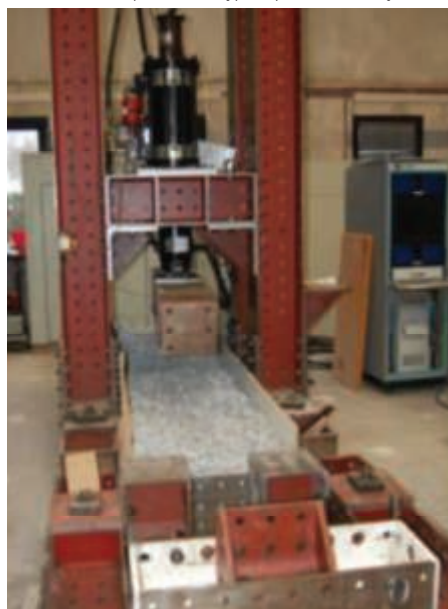
2. Stanowisko badawcze powierzchni kontaktu podrozdniczcy z ziarnami tłuczni
