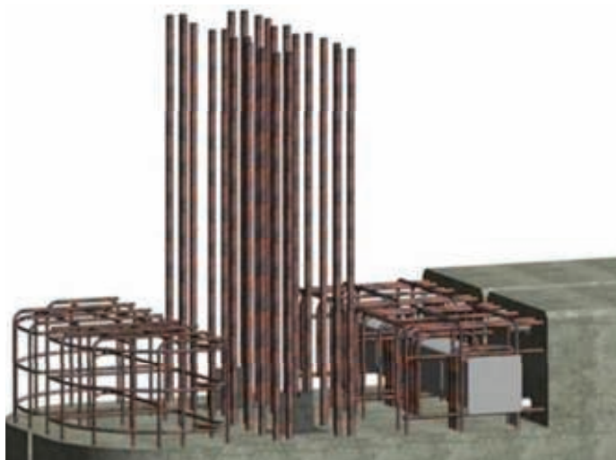
6. Wizualizacja przerwy roboczej w oczepie filara układu zespolonego [2]
