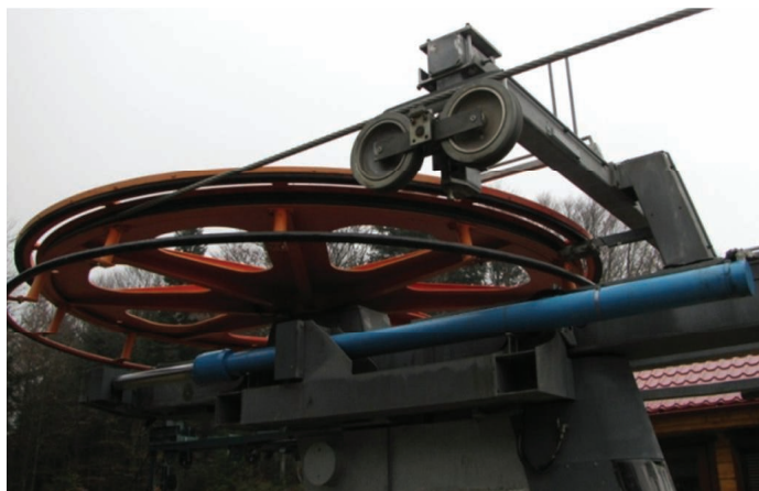
3. Hydrauliczne urządzenie napinające kolei linowej „Slotwiny TAB” w Krynicy Zdroju [4]
