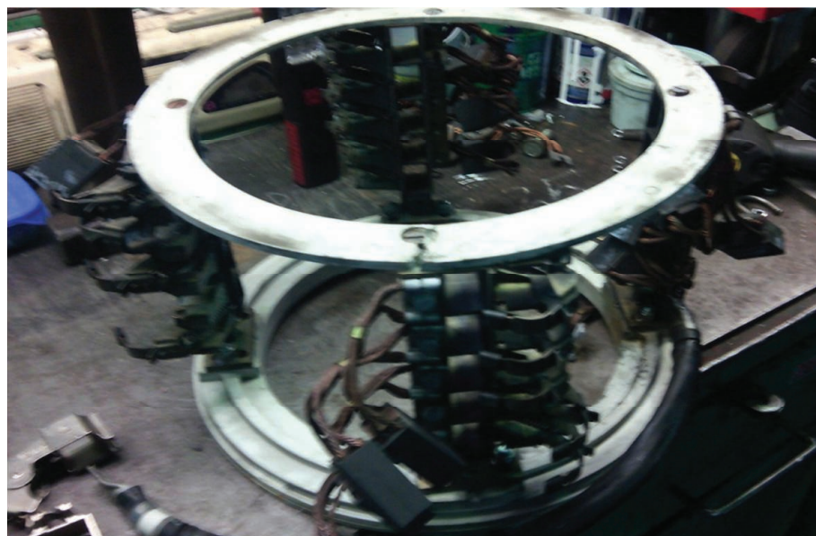
5. Widok pękniętego pierścienia mocującego ramiona aparatu szczotkowego
