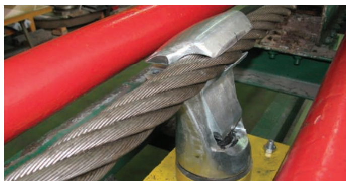
2. Badanie siły przesuwu wpręgła na linie nośno - napędowej
