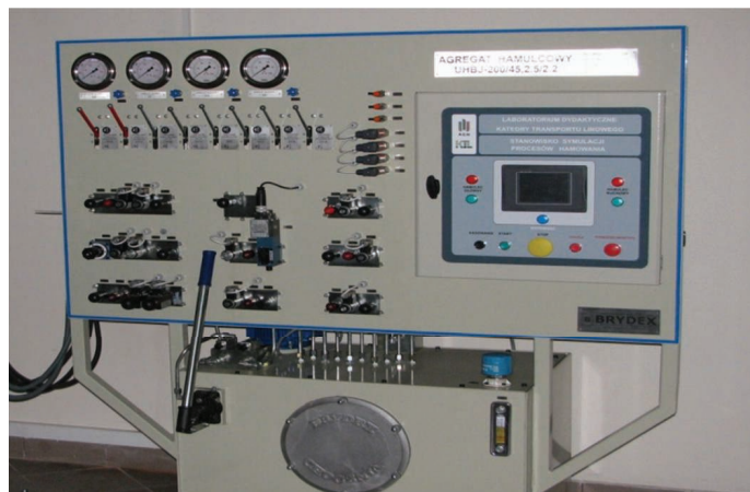
4. Stanowisko laboratoryjne do badań układów hamulcowych
