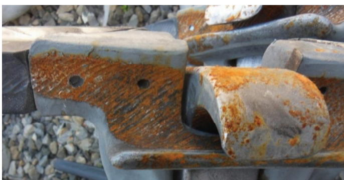
1. Wpręgło z widocznymi odgnieceniami od liny
